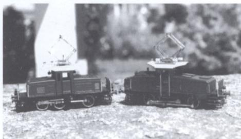
Hier werden die unterschiedlichen Aufbauten der BLS- und SBB-Maschine besonders deutlich (Modelle Metrop H0).
